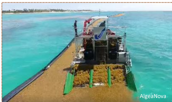
Le bateau de collecte de sargasses d'AlgeaNova travaille à l'extérieur du barrage anti-sargasses.
